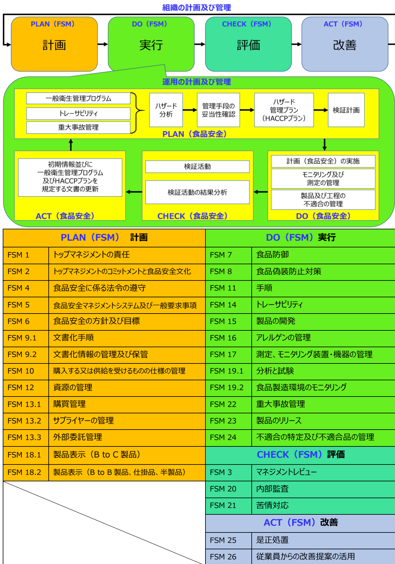
図 1 JFS-C 規格の食品安全マネジメントシステムにおける 2 つの PDCA サイクルの概念図
